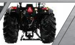
CAPACIDAD DE LEVANTE HIDRÁULICO 4,500 KG
